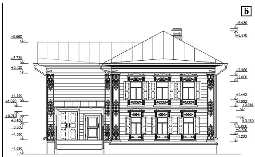
Ил. 28. Жилой дом (г. Ханты-Мансийск, ул. Кирова, д. 22). Южный (уличный) фасад: А — кроки, Б — реставрация
