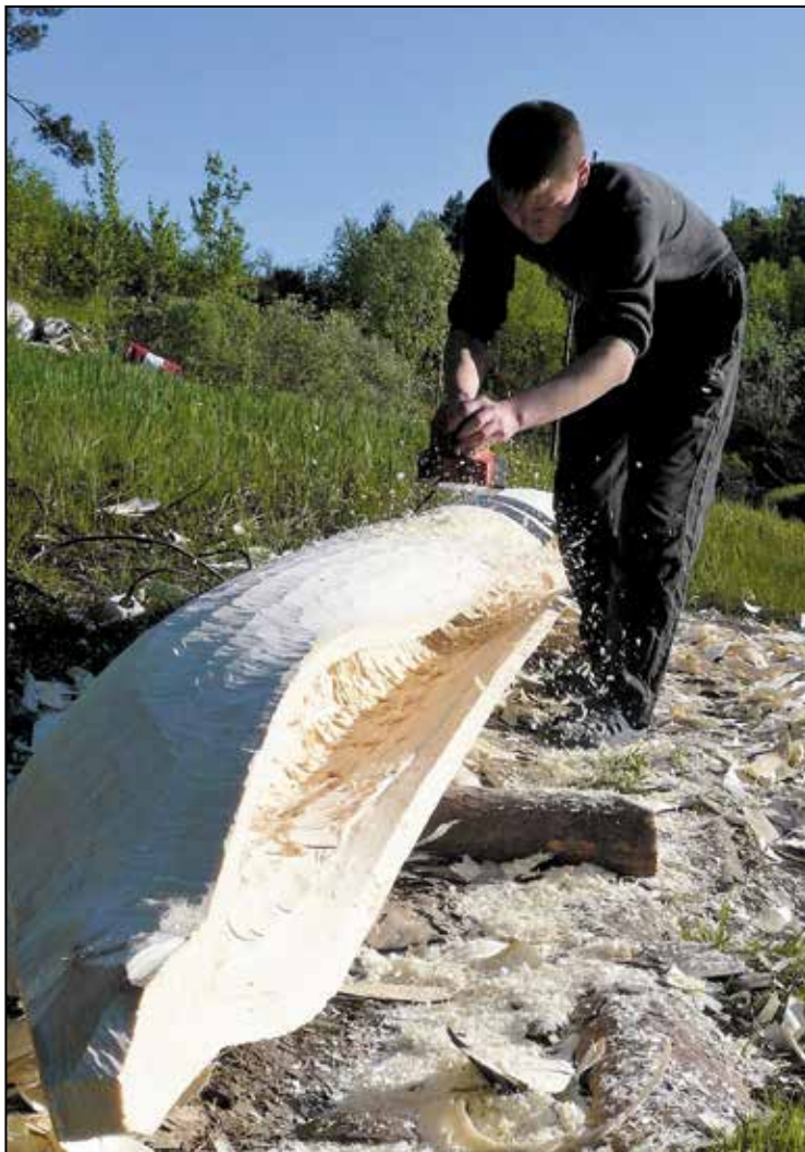
Обработка внешних сторон бортов с помощью электрорубанка. Ханты Каймысовы. Р. Малый Юган. Стойбище Киняминых. 2009 г. Фото: А.А. Рудь
