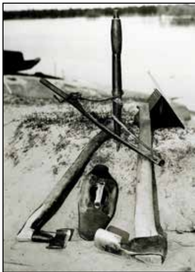
Традиционные инструменты для изготовления долблёной лодки: прямое и боковое тёсла, струг, лучковое сверло. Ханты. Р. Вах. 1913 г. Фото: Г.М. Дмитриев-Садовников
