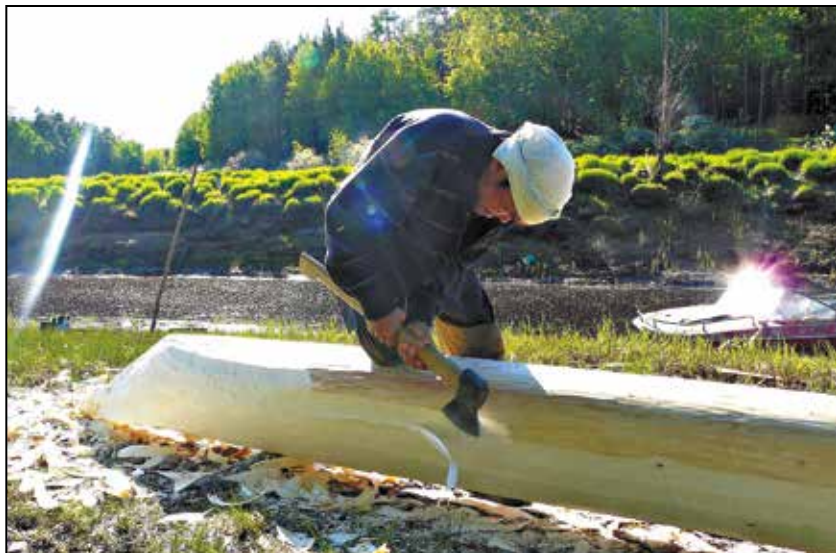
Формирование внешних сторон бортов с помощью топора. Ханты Каймысовы. Р. Малый Юган (юрты Кинямины). 2009 г. Фото: А.А. Рудь
