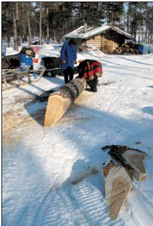
Первичное оформление торцов заготовки в корму и нос обласа. Ханты. Р. Энтль-Юхлынгяун (бассейн р. Пима). Стойбище Ф.Н. Востокина. 2011 г. Фото: А.А. Рудь
