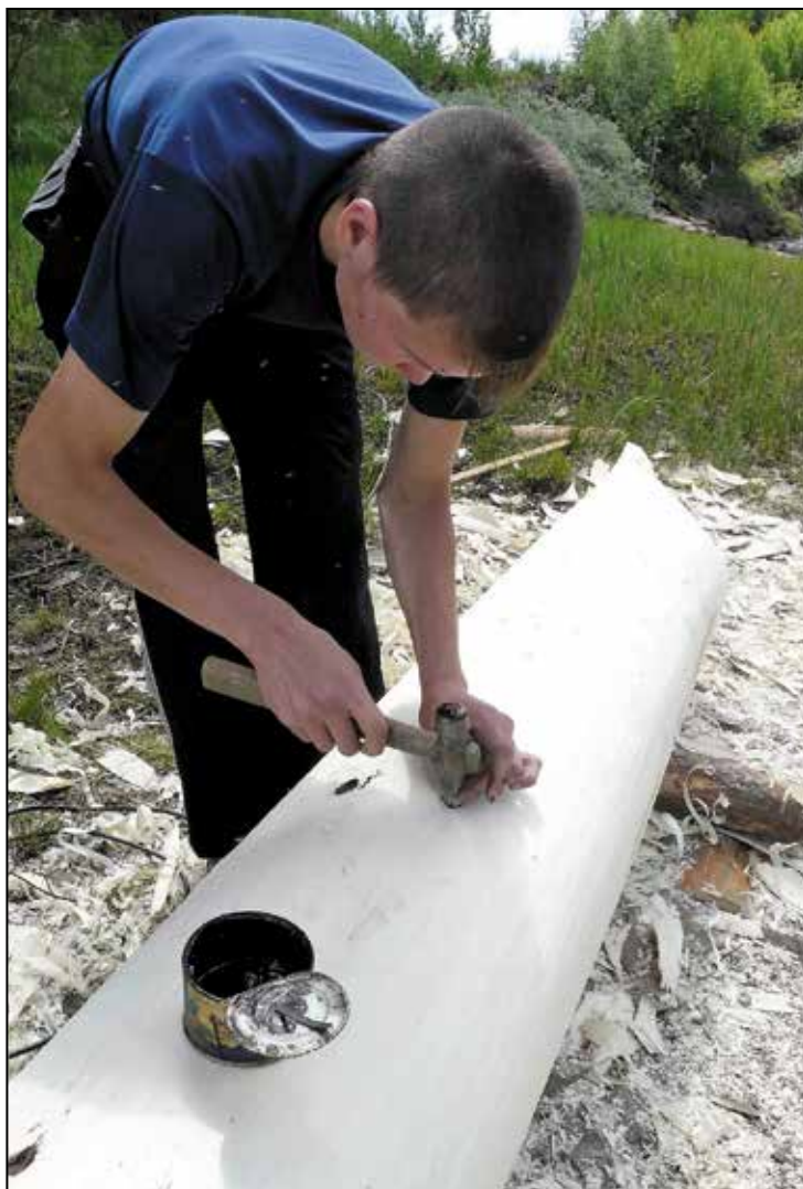
Вбивание окрашенных сторожков (чопиков) в борта лодки для формирования одинаковой толщины последних. Ханты Каймысовы. Р. Малый Юган. Стойбище Киняминых. 2009 г. Фото: А.А. Рудь
